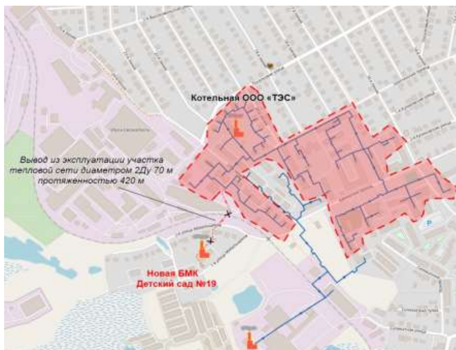
Рисунок 6.5 – Решение по оптимизации теплоснабжения объекта Детский сад №19
