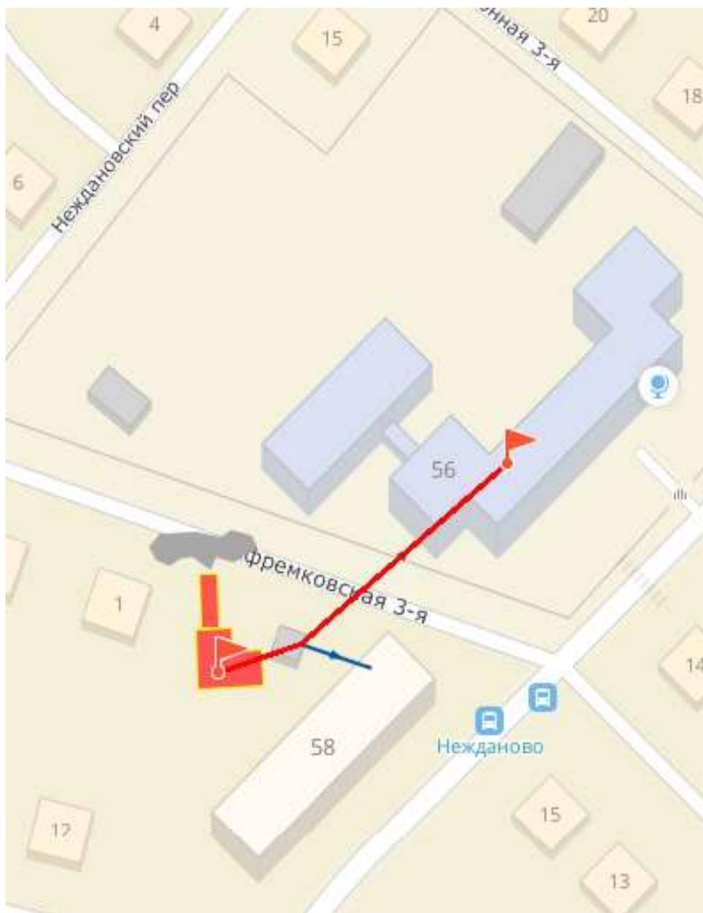
Рисунок 27 – Путь движения теплоносителя от источника тепловой энергии до конечного потребителя, в зоне действия котельной № 41 (рисунок П46.1 Указаний)
