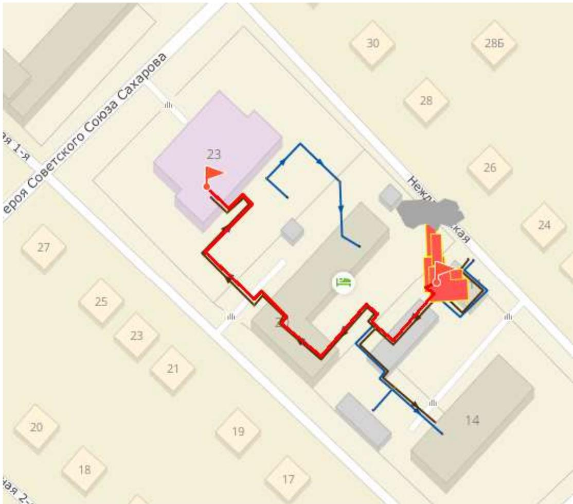
**Рисунок 19 – Путь движения теплоносителя от источника тепловой энергии до конечного потребителя, в зоне действия котельной № 25 (рисунок П46.1 Указаний)**
