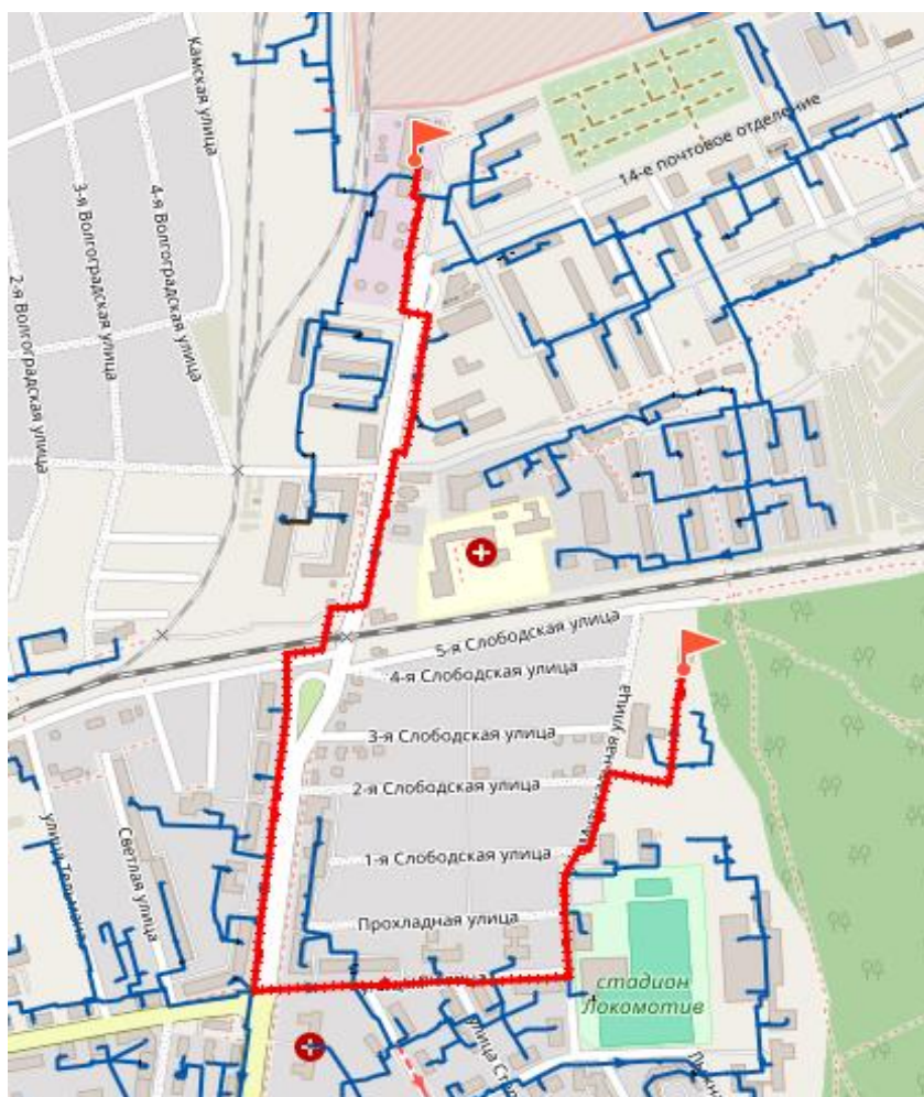
Рис. 13.11 Путь теплоносителя от котельной №37 до конечного потребителя
