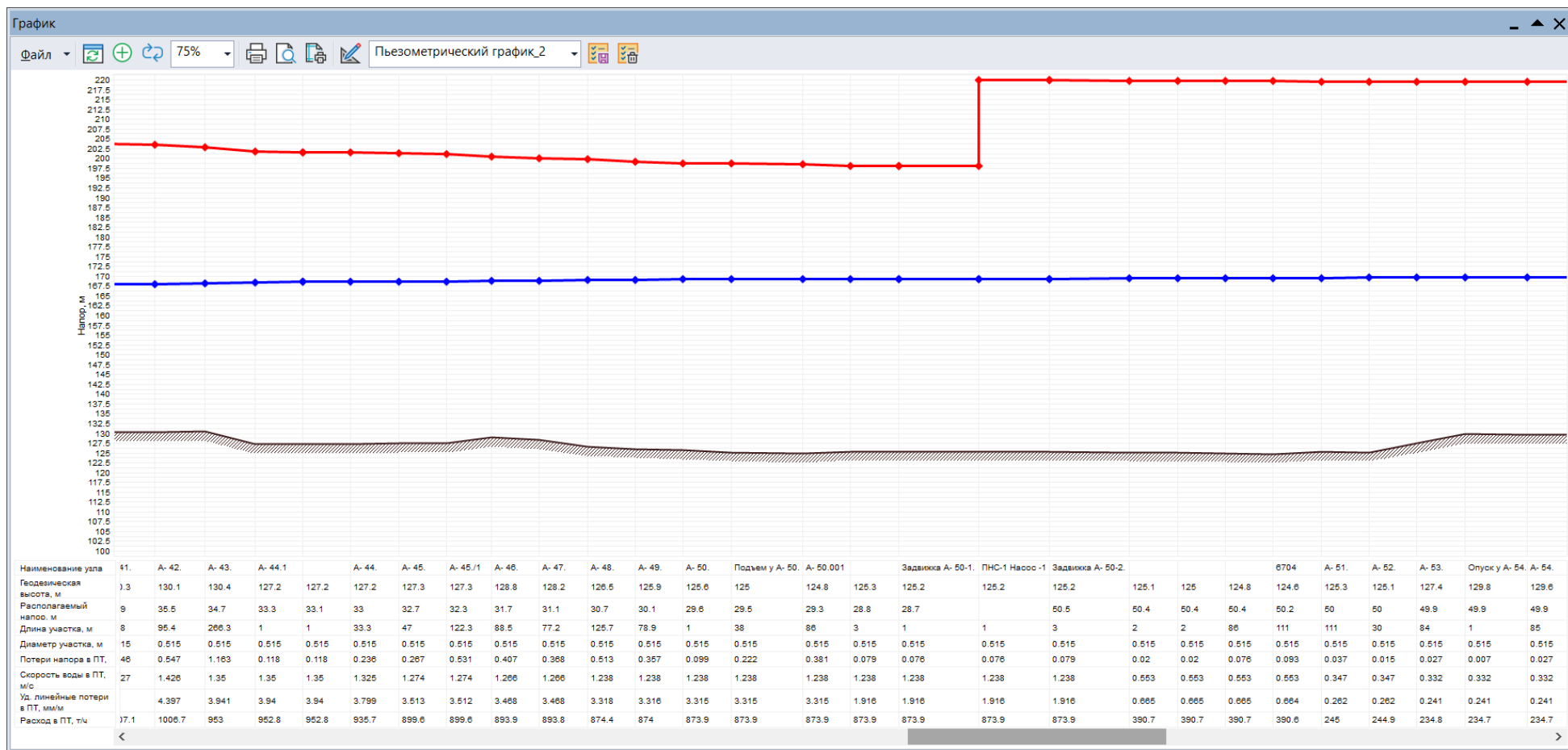
Рис. 13.71 Пьезометрический график от ИвТЭЦ-2 до удаленного потребителя ул.Генерала Горбатова 19 (продолжение 3)
