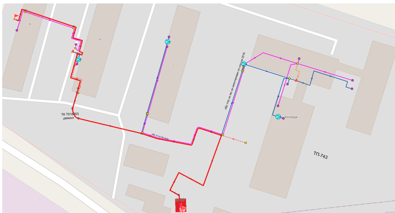
Рис. 13.7 Путь теплоносителя от котельной №18 до конечного потребителя
