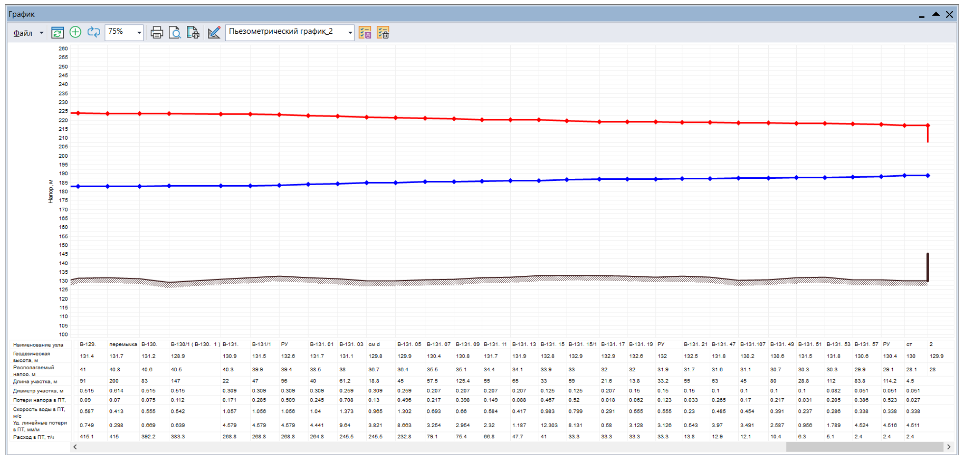
Рис. 13.80 Пьезометрический график от ИвТЭЦ-3 до удаленного потребителя ул.Некрасова 45 (окончание)
