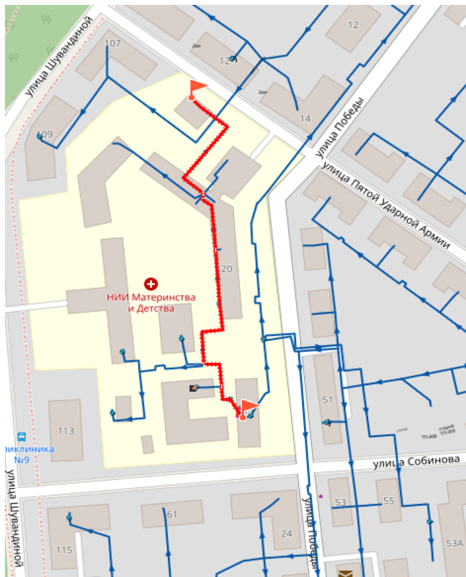
Рис. 13.28 Путь теплоносителя от котельной №19 до конечного потребителя
