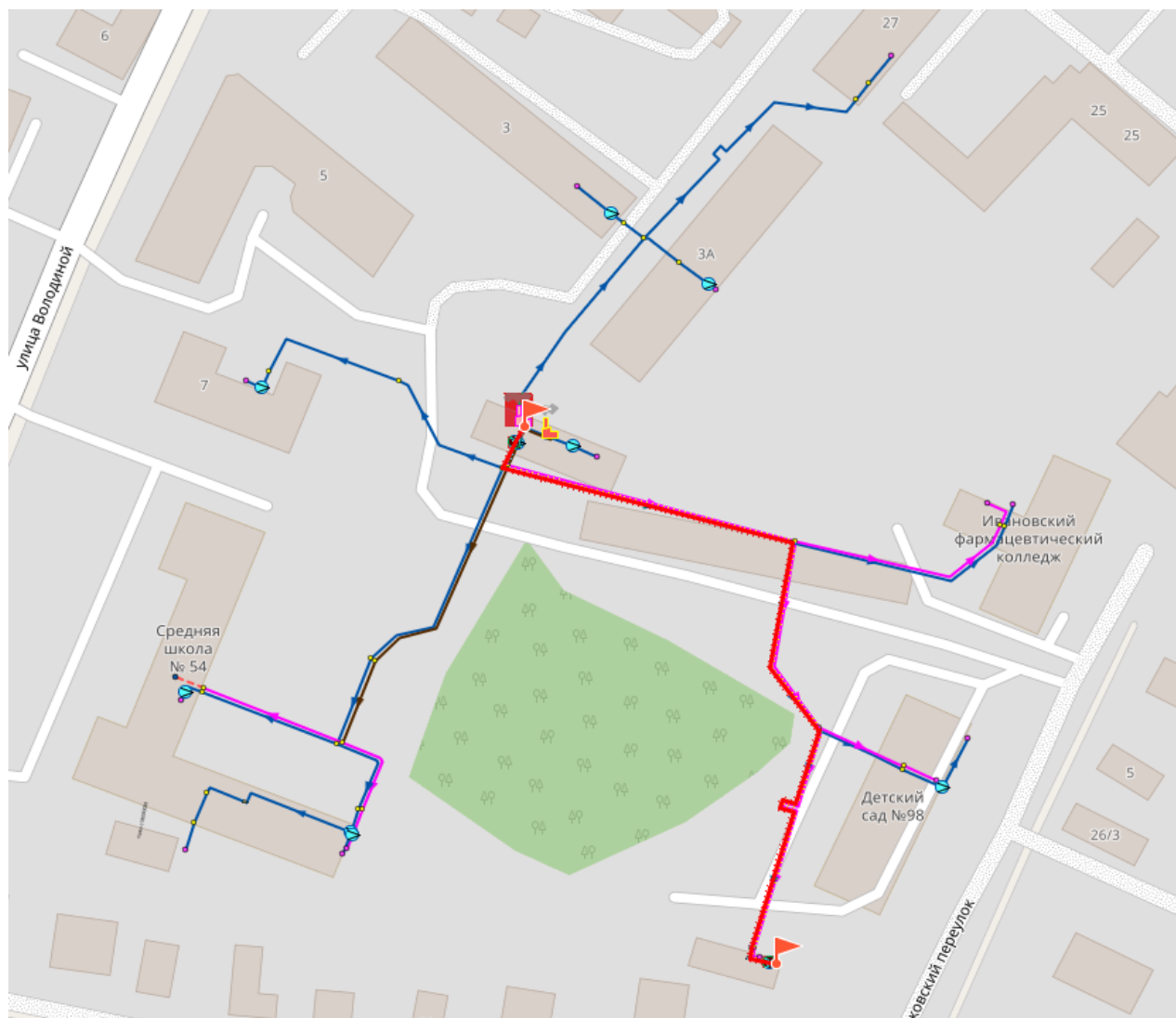
Рис. 13.9 Путь теплоносителя от котельной №30 до конечного потребителя
