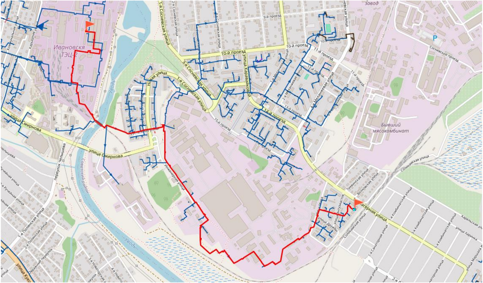
Рис. 13.51 Путь теплоносителя от ИвТЭЦ-2 (вывод С) до удаленного потребителя ул.Соликамская 26
