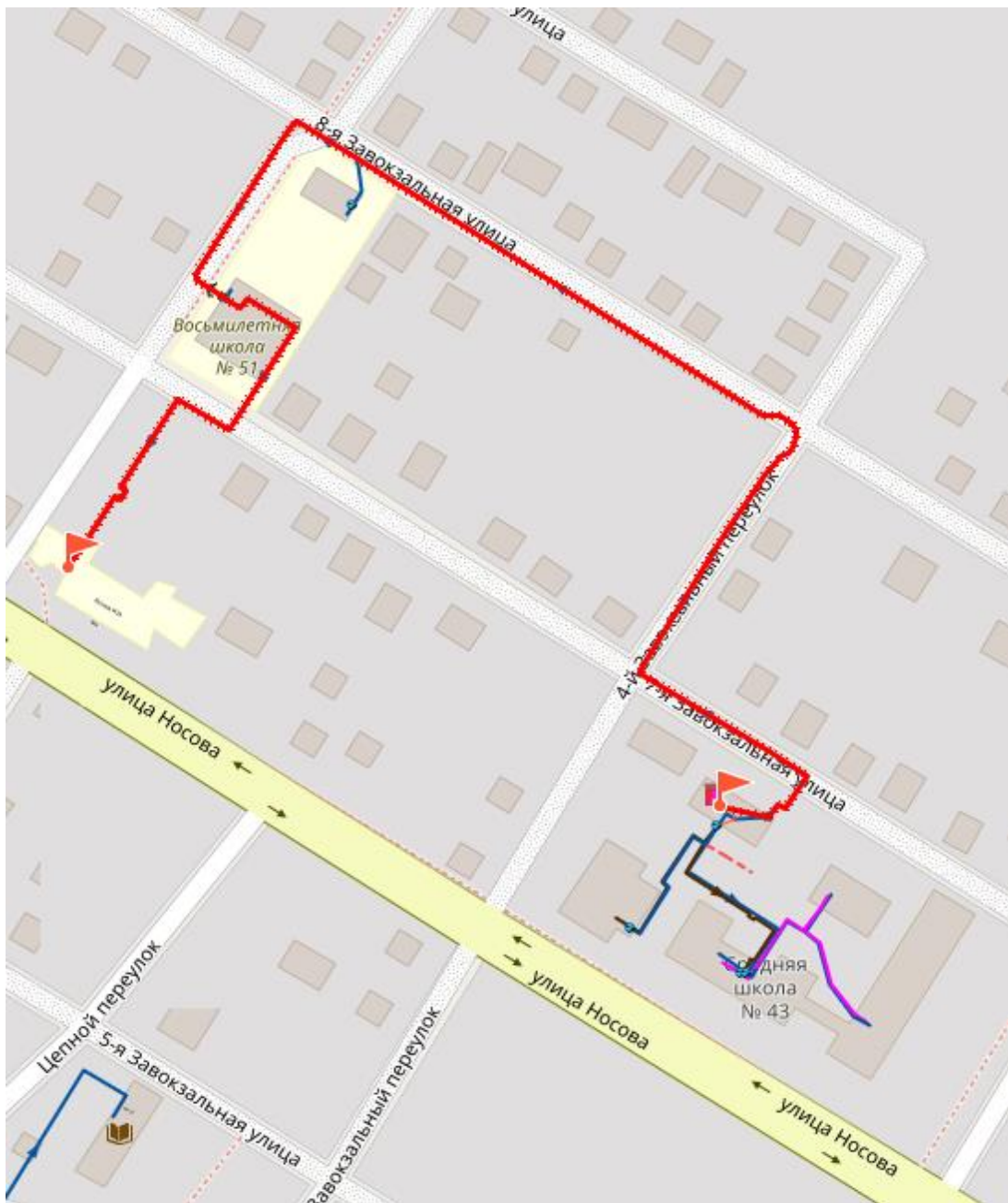
Рис. 13.33 Путь теплоносителя от котельной №24 до конечного потребителя
