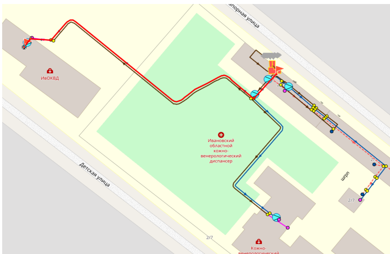
Рис. 13.5 Путь теплоносителя от котельной №10 до конечного потребителя
