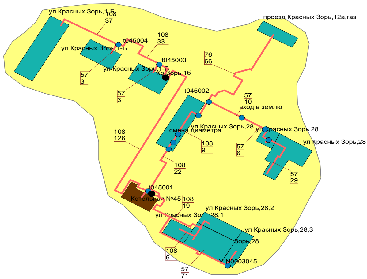
Рис. 4.19 Зона действия котельной №45
