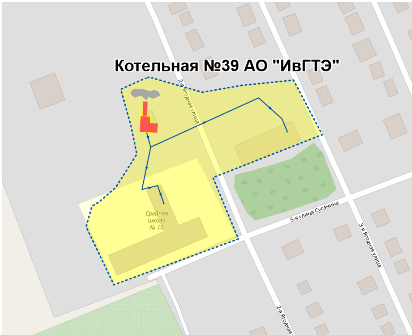
Рис. 4.16 Зона действия котельной №39
